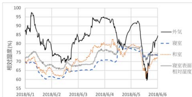
図12 RC造NM邸 和室、寝室、外気の温度、絶対湿度及び相対湿度の比較
